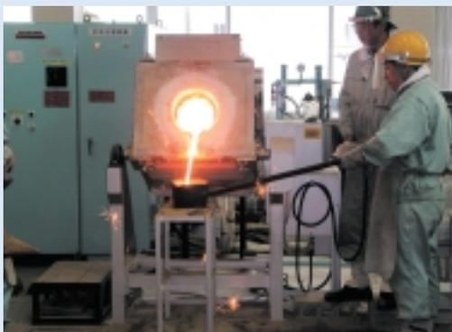
金属を溶かして、型に流し込む実習をしています
