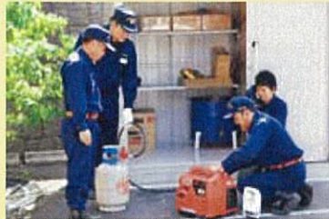
川上村では防災備蓄倉庫7か所にLPガス発電機(0.85kW)とLED投光器等を整備
