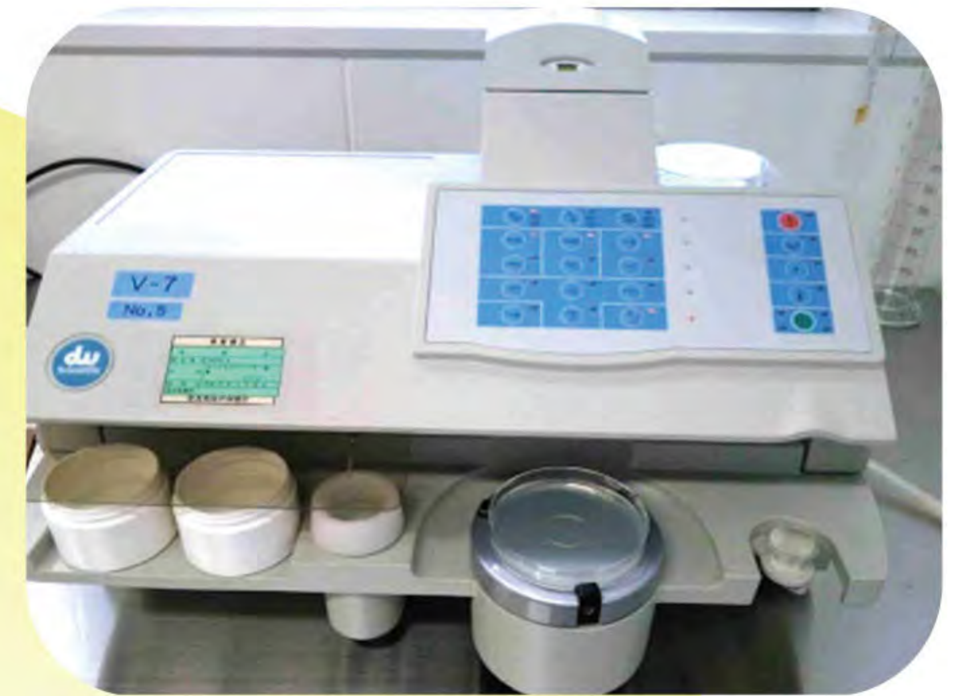
スパイラルプレーター (食品の希釈液を培地に塗抹します)
