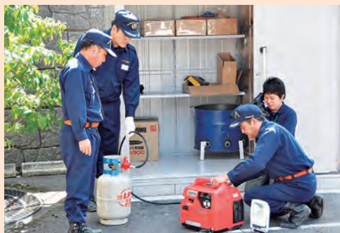
災害にも強いポータブルのLPガス発電
