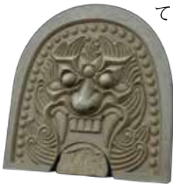
発掘されたものにならって型押しした鬼瓦を乾燥へ
