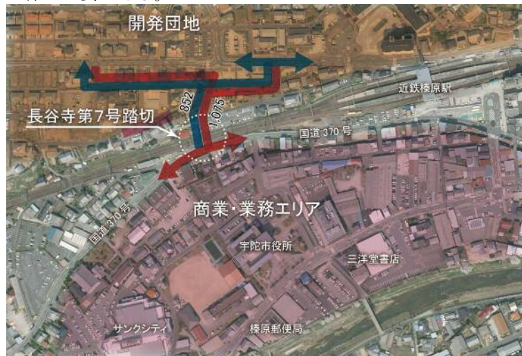
図 長谷寺第7号踏切の12時間交通量 (平成28年9月15日調査)
