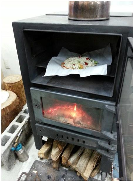
ロケットストーブの原理で燃焼効率が高く針葉樹が燃やせる。クッキングストーブ。
