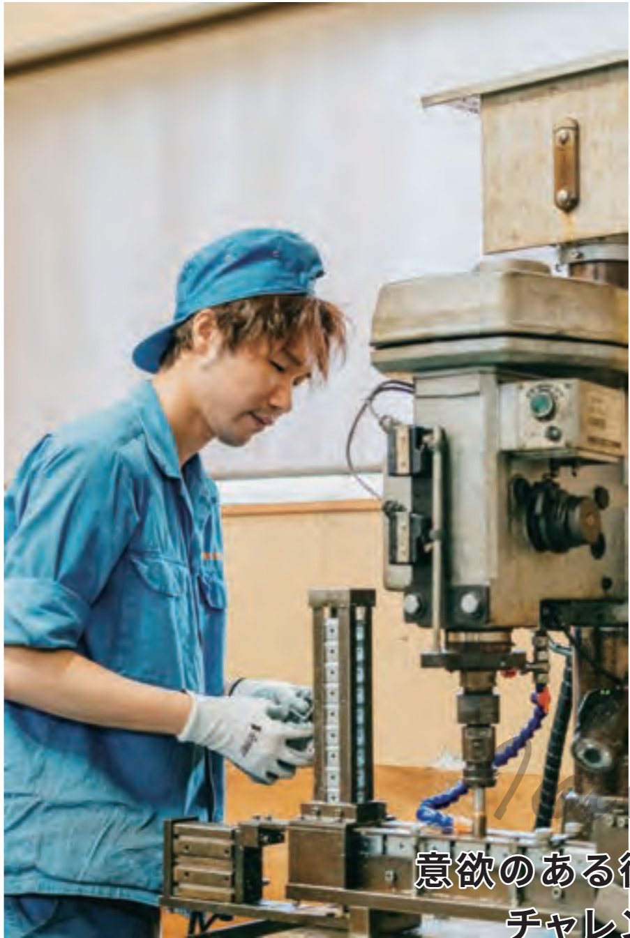
金属の部品を機械に通すと、ネジが打ち込まれ、奥側に落ちる。この機械の操作がこの日の西川さんの仕事だ。
