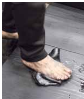
原料を攪拌機で混ぜて良く練った墨玉を、より均一に混ぜるため手と足で良く練ります(足練り)
