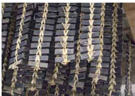
木型から取り出した墨は、急激に乾燥させると割れるため、灰の中に埋めて徐々に乾燥させた後、稲わらで編んで天井からつるし、空気乾燥させる。
