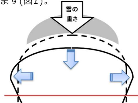
図1 パイプハウスの崩壊過程
