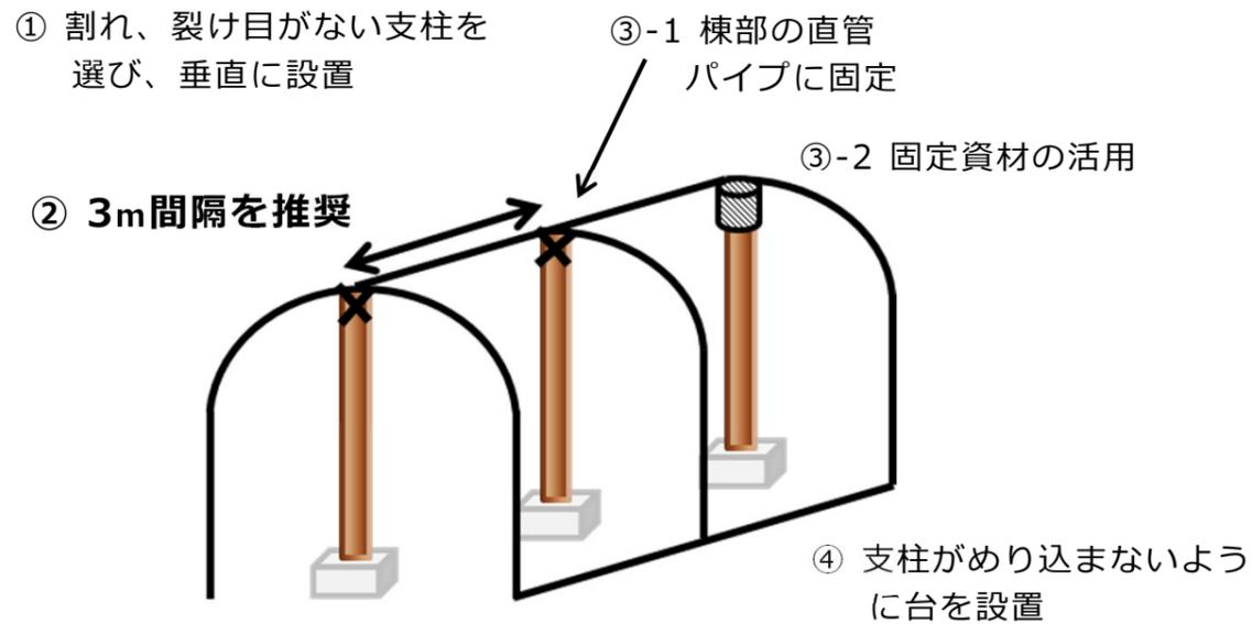
図2 支柱設置の注意点
