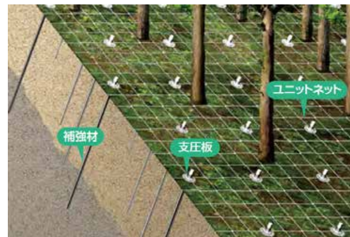
施工イメージ
