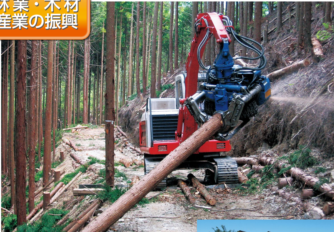
高性能林業機械による造材
