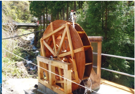
小水力発電設備の水車（十津川村重里地区）
