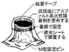
アスファルト系水性接着剤の塗布
