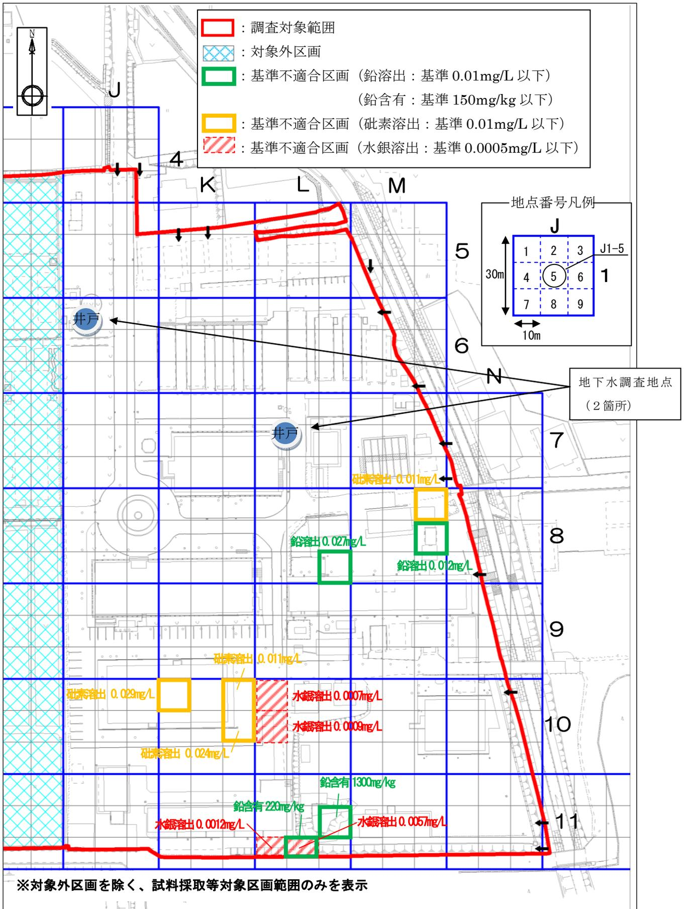
図1 現況地表面・地下ピット及び地下配管深さにおける基準不適合区画
