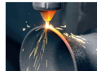
レーザー金属積層造形と 5軸ミーリング加工の融合
