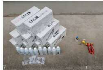
注入孔 100 個の処理に必要な薬剤量の比較（左：従来薬剤、右：高濃度濃縮型）
