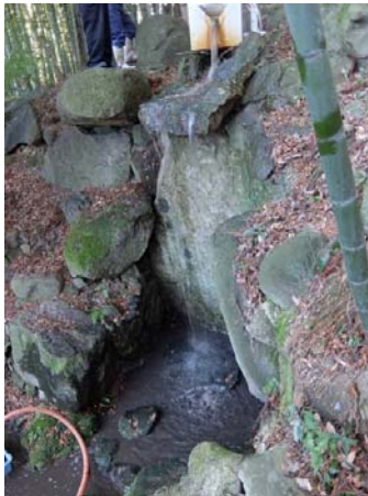
揚水試験の様子 (60L/min)
