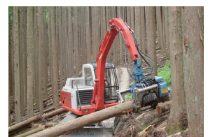
奈良型作業道と高性能林業機械を組み合わせた木材生産の現場
