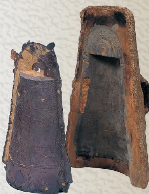
鑄造実験の鑄型と鑄放しの銅鐸
