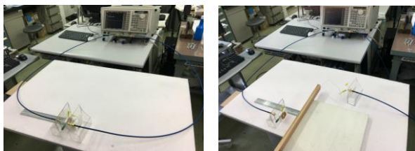
図 3 Sパラメータの測定
