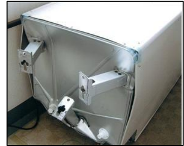
電気温水器の貯湯タンクの脚が曲がった様子 (国民生活センター公表資料)
