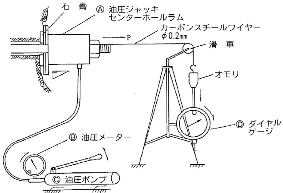
図-3 引抜試験概要図
