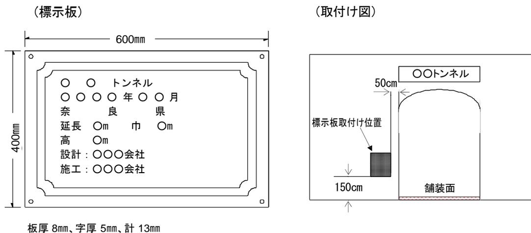
図10-6-2 標示板の刻示標準図
