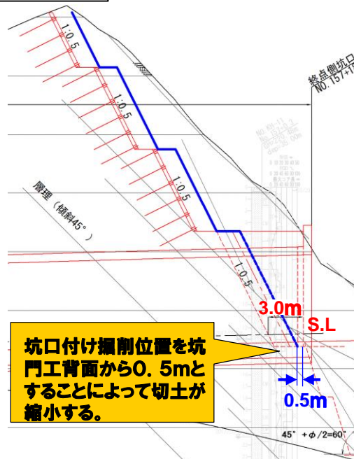
2号トンネル南側坑口縦断面図
