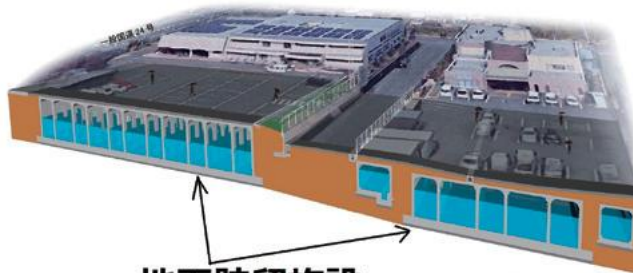
地下貯留施設
