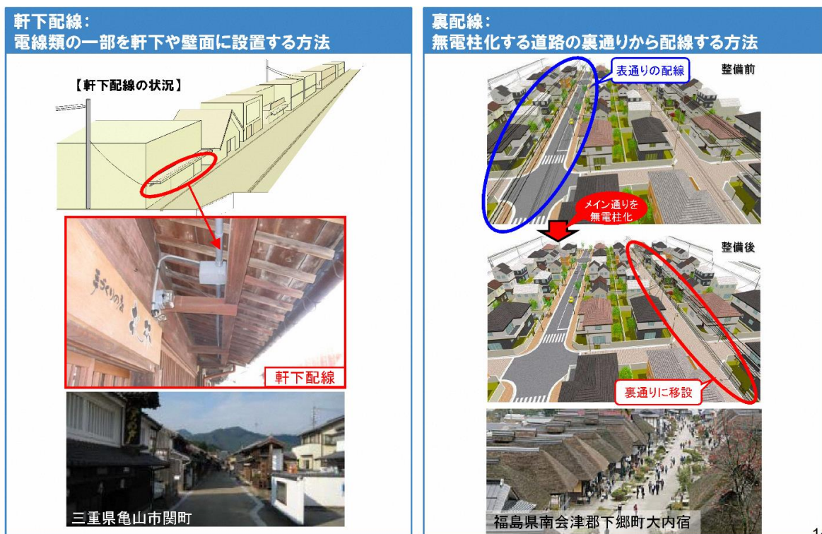
図 12 地中化以外による無電柱化の事業手法（軒下配線・裏配線）
