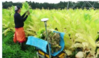
作業者を自動で追従し、農作物の運搬作業を軽減
