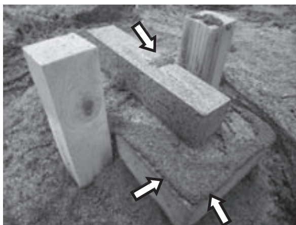
(3) 銅添加の柿タンニンを塗布した試験体
