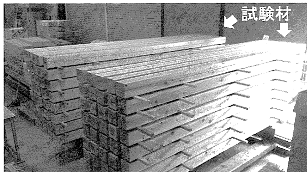
図3 仕上げ加工後の試験材を静置する様子 手前: スギ試験材 奥: ヒノキ試験材
