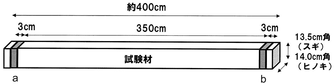
図1 試験体の調製方法
