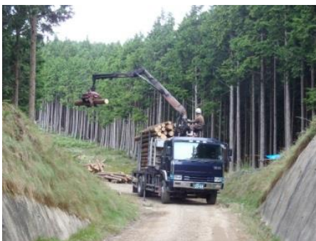
グラブ付きトラックによる木材の積込
