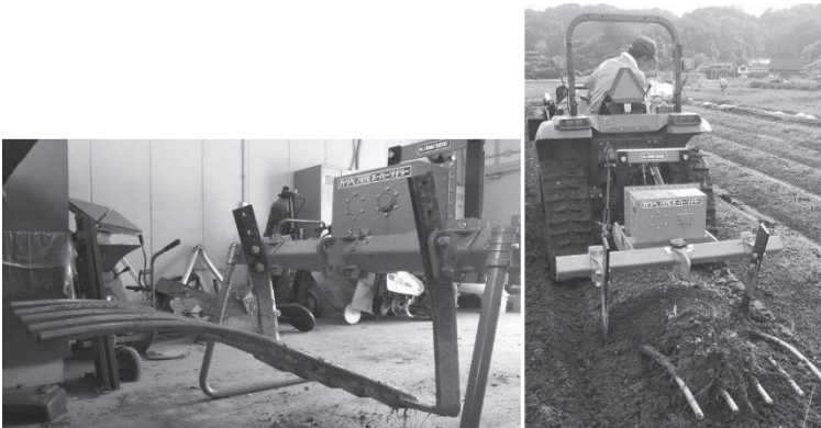
第1図 試験に用いた振動式デガーの外観と機械利用による掘り上げ作業の様子 Fig. 1. Appearance of tested vibrating digger and mechanized digging
