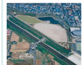
遊水地 河川の流水を遊水地内に越流させることにより、下流の氾濫を軽減します。
