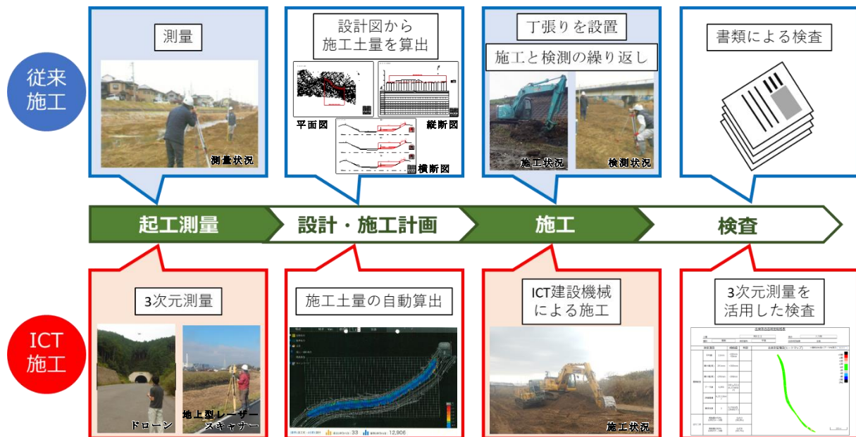
図-1 従来の施工と ICT 施工の違い
