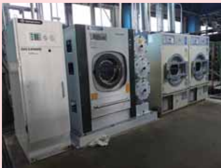
蒸留機搭載石油系ドライ機(ドライクリーニング・マシン)
