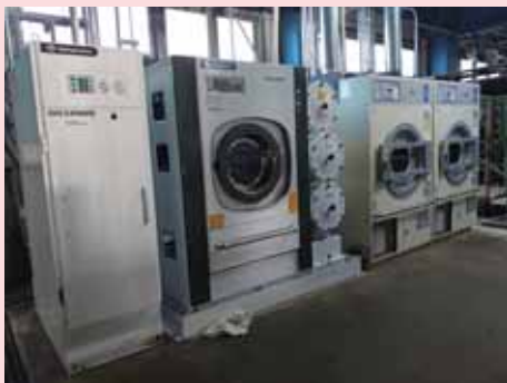
蒸留機搭載石油系ドライ機(ドライクリーニング・マシン)
