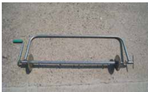
図 39 手動式のフラワーネット回収装置と使用方法
