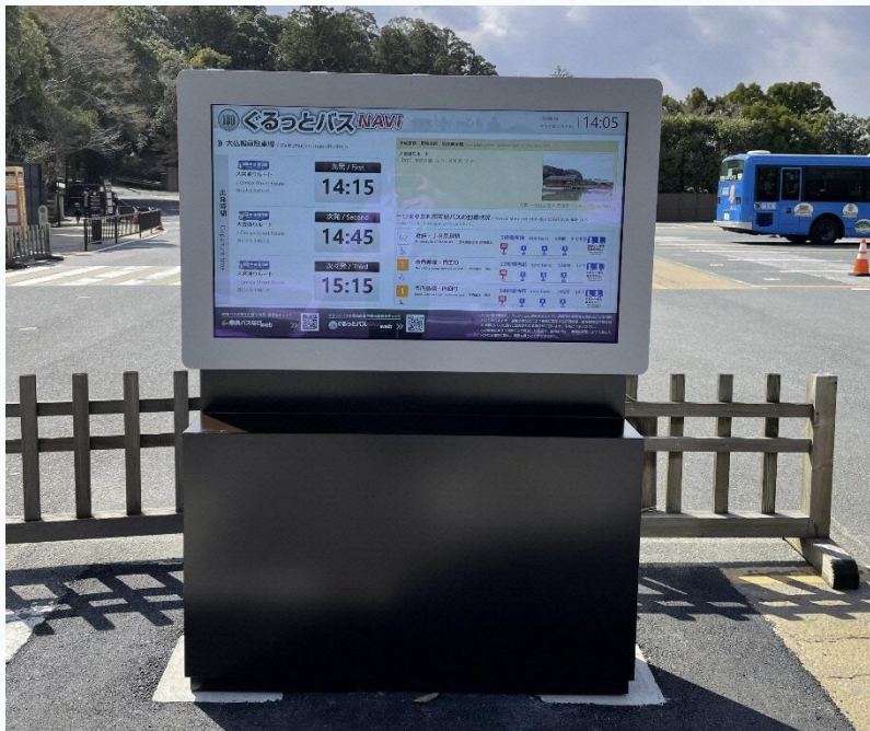
バスロケーションシステム(サイネージ版):大仏殿前駐車場バス停
