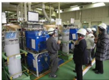
2016年施設見学:関西リサイクルシステムズ(株)家電リサイクルの現場、フロンガスの回収
