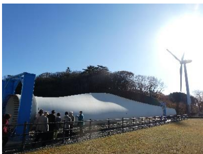
ブレード（約40m.ガラス繊維強化プラスチック製）
