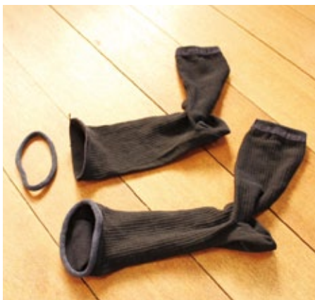
先縫い工程の靴下(下:筒状の状態 上:ハギレが切り落とされた状態)
