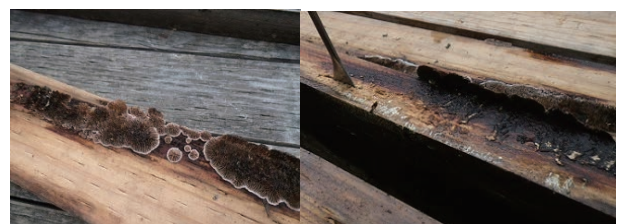
図6 3年経過後の無処理スギ試験体の被害状況 (左) 木材腐朽菌の子実体 (右) 腐朽状況(ダブルレイヤー試験)
