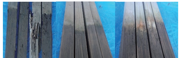
図5 3年経過後の杭試験体の地際部の様子 (左：無処理スギ心材、中：銅系処理材、右：有機系処理材)
