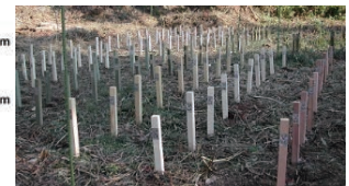
図1 野外杭試験の設置方法
