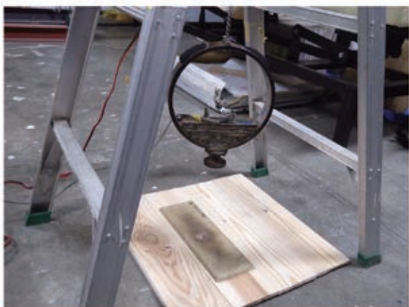
床材の衝撃吸収性能試験の様子 (詳しくは2～3ページ)
