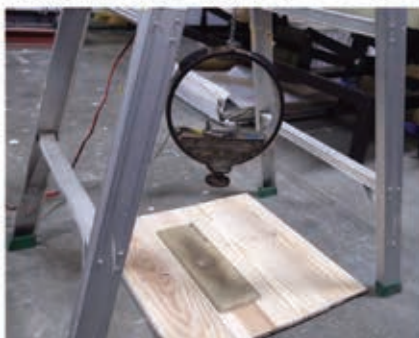
図1 衝撃吸収性能試験の様子
