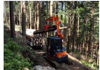
車両による集材に適した奈良型作業道
