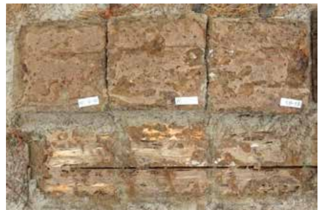
図5 ばく露1年経過(上段)および5年経過(下段)の試験体下面 (吹上浜試験地 左からWL18、WL12、WLO 写真下半分はSPF材)
