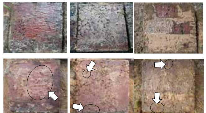
図6 吹上浜試験地におけるばく露1年経過(上段)および5年経過(下段)の試験体下面 矢印はばく露5年経過時にみられた蟻害を示す (蟻道除去後 左からWL18、WL12、WLO)
