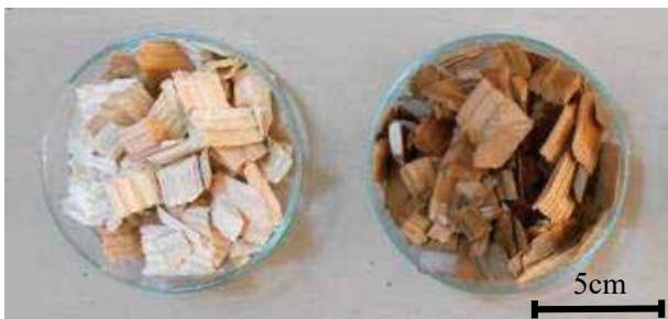
図1 ブロック型舗装試験体に使用した木チップ (左：無処理、右：半炭化処理)
