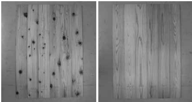
図3 節あり(左)、節なし(右)の試験体
