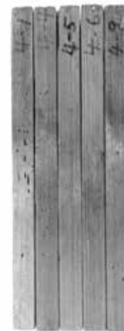
図3 明日香実験林において設置後 15 年経過した MA 処理杭（残存分） MA/wood：30/100
