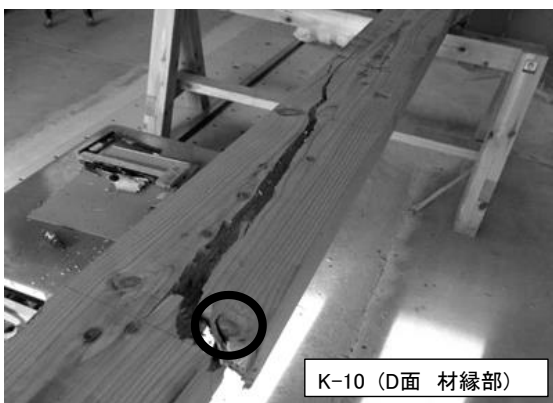
図9 曲げ試験において破壊の起点と考えられる節 注) 該当の節を黒丸内に示す。括弧内は節が位置した材面を示す。
