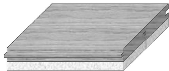
図3 耐荷重試験 試験体
