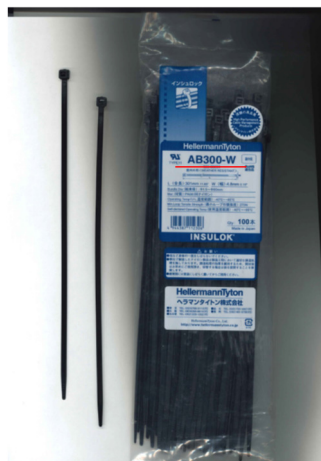
図21 破断した結束バンド (AB300-W)
